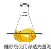
錐形瓶使用穿透光量測
